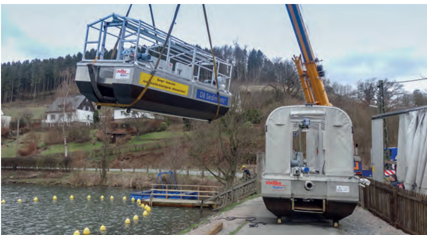
Abb. 3: Beispiel für Geräte für den automatischen Sedimenttransfer (Bildquelle: DB Sediments)
